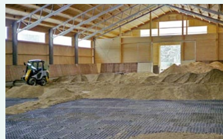
TTE®-gitterblok specielt til ridehaller med integrerede vandreservoirs (effektiv 8 l/m 2 ).
